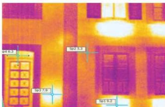
Grâce à une caméra thermique, visualisez les déperditions de votre logement (parois, ponts thermiques, réseaux de chaleur).
