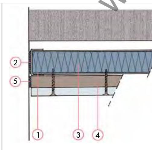
Constituer une ossature en métal ou en bois **(1)** fixée aux murs en plaçant entre cette ossature et les murs un **Rouleau de Jute Antibruit Acoustix (2)**.
