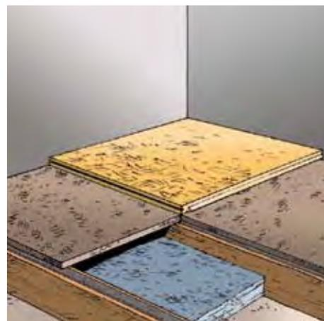
POSE SUR GRANULAT DE RAGRÉAGE OU SUR TAPIS DE JUTE
