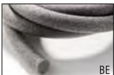
Assure la réalisation de l'étanchéité périphérique et la désolidarisation de la couche isolante acoustique. De par sa structure ronde, il est introduit mécaniquement dans l'interstice laissé entre l'isolant et le mur. Il prend la forme du mur ce qui est particulièrement apprécié en rénovation quand les interstices ne sont pas réguliers.
