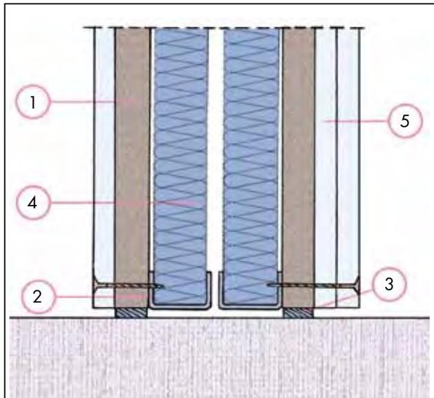
Cette cloison constituée d'une double ossature métallique de 48 mm **(2)** contient le matériau absorbant acoustique en chanvre cellulosique de 45 mm. **(4)**
