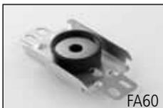
Pour la réalisation de doublages acoustiques minces de murs et de plans inclinés sur profilés métalliques. Offre une désolidarisation et un encombrement réduit. Fixation en acier galvanisé avec en son centre une rondelle de soutien en caoutchouc et une rondelle métallique.
