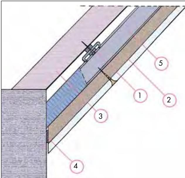
Sous une toiture au préalable thermiquement isolée avec un matériau absorbant (5), on applique un contre-lattage en bois, ou encore idéalement des profilés de type 60/27 clipsés dans des **fixations antivibratoires Acoustix (FA60) (1)**. Sur ce support, vient se fixer à l'aide de vis le panneau **Acoustix Pan-terre Plâtre** ou **Fibro-plâtre (2)**.
