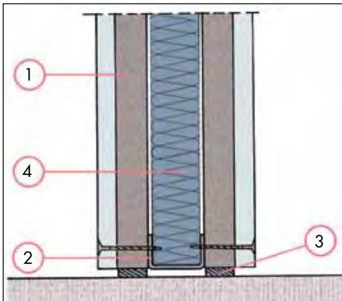
Suivant l'espace dont on dispose et le niveau d'isolement acoustique que l'on souhaite obtenir, on choisira de fixer à l'aide de vis les panneaux **Acoustix Pan-terre Plâtre** ou **Fibro-plâtre (1)** sur une ossature simple ou sur un jeu de deux montants verticaux, l'ossature alternée ou double.
