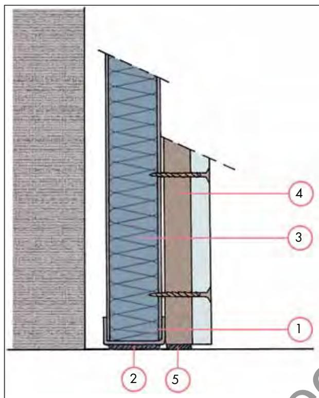
Réaliser une ossature **(1)** fixée au sol et au plafond sans contact avec le mur à doubler.
