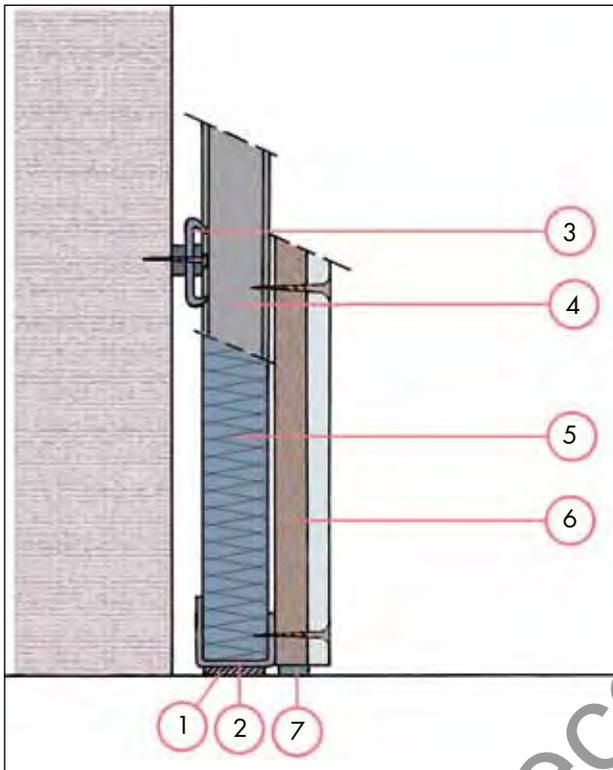
Fixer les rails en U (1) au sol et au plafond à 8 mm de la paroi à doubler.
